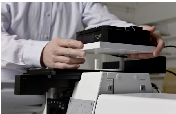
Abb. 6 Die Feinjustierung von Objekt oder Probe übernimmt das Piezo-Nanopositioniersystem, das nicht nur hochgenau arbeitet, sondern sich auch gut in die Applikation integrieren ließ (Bild: PI / Nanoscribe GmbH)
