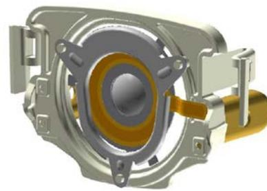
Abb. 3 Der Piezoring ist direkt mit dem Metallring der Membran verklebt. Beim Anlegen der Wechsellspannung schwingt das Piezoelement mit einer Frequenz von ca. 35 kHz (Pari Pharma/PI)
